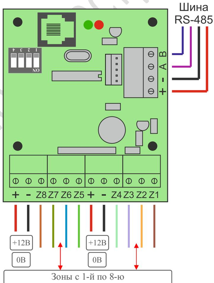
**Внимание! Клеммы +12В и 0В (GND) предназначены для подачи питания на шлейфы!**
